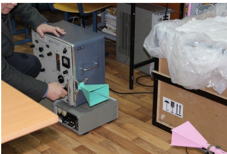
Рисунок 6. Экспериментальная установка для измерения СВЧ излучения без контейнера (СВЧ генератор с подключенной передающая рупорная антенна (салатный цвет) и приемная рупорная антенна (желтый цвет))
