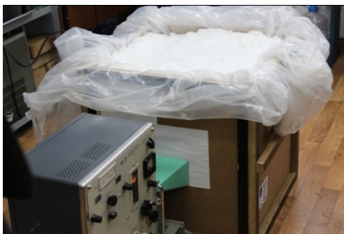
Рисунок 7. Экспериментальная установка для измерения прошедшего СВЧ излучения в случае полного заполнения РПМ контейнера (толщина слоя РПМ между раскрывами рупорных антенн-53 см)
