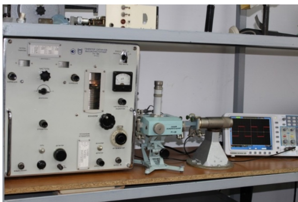
Рисунок 8. Экспериментальная установка для изучения диэлектрических характеристик РПМ волноводным методом, (слева показан СВЧ генератор, правее к генератору подключена с помощью фланцевого соединения измерительная линия Р1-28, справа к нему подключена волноводная секция с РПМ, за которым подключаются короткозамкнутыми волноводными нагрузками с переменной фазой НКП-7, к измерительной линии подключается осциллограф).
